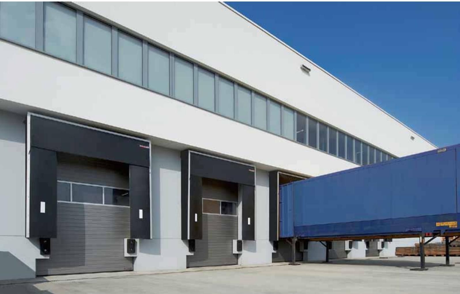
霍曼簾板式門封可以根據車廂尺寸靈活調整，適用於各種場合。還可以有月台式、落地式等多種款式可以選擇，因此能夠滿足絕大多數客戶的需要。高品質的頂部和側部簾板，裝在可伸縮的鍍鋅鋼框架上，構成了既穩固耐用，又靈活柔韌的結構。
