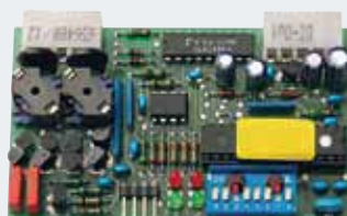
地磁感應器 雙通道地磁感應器，可同時支持兩個獨立的地磁線圈， 供貨時包括線圈銅線。
