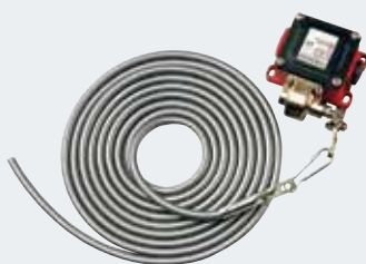
拉繩開關 可以水平或垂直安裝，鑄鉛殼體，防護等級：IP 65 拉繩長度為 4 m
