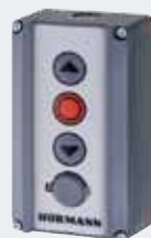
按鈕開關DTH RM 獨立的開/停/關按鍵 帶迷你鎖：用於鎖閉開關鍵功能，防止無關人員開啟大門 (配2把鑰匙) 防護等級：IP 65 尺寸：90 × 160 × 55 mm (W × H × D)
